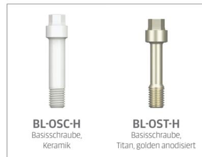
Den Temporär-Abutments liegt eine golden anodierten Basisschraube BL-OST bei. Die Schraube BL-OST wird mit dem Schraubendreher BL-SD-ST oder BL-SD-LT und maximal 15 Ncm eingedreht.
